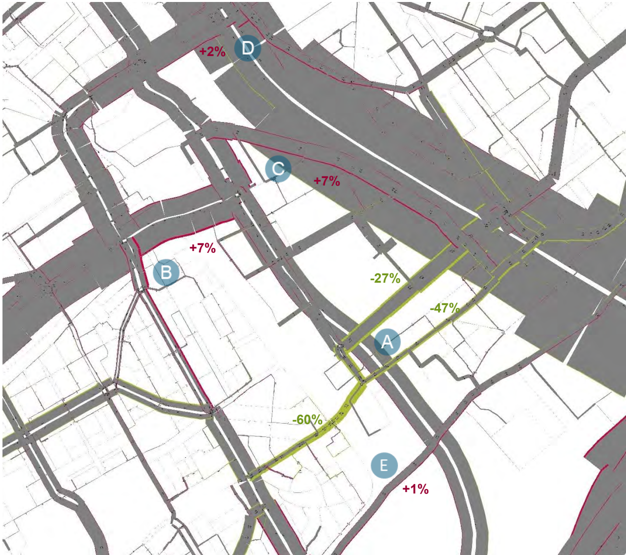
Figuur 17 Verschillenplot etmaalwaarden Variant 1 t.o.v. Basisscenario 2040 (Bij deze verschillenplots betekent groen een afname en rood een toename van het van het autoverkeer)
